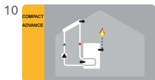
Solar com termóstato (aquec. auxiliar).
