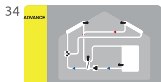
Solar com 2 colectores, válvula de 3 vias e permutador de calor.
